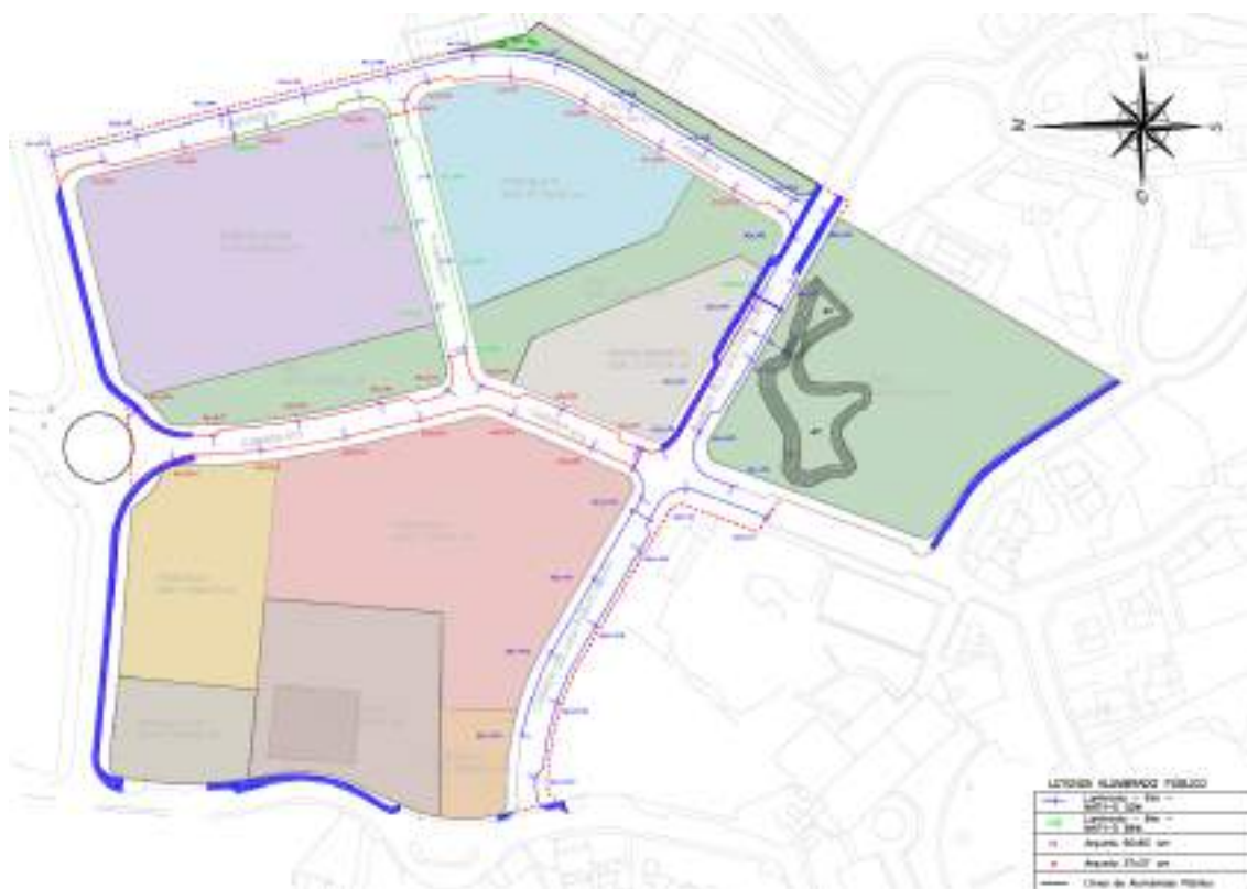
Figura 22. Red de baja tensión
